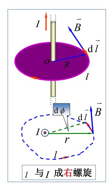
规定: 当电流流向与积分路径的绕行方向成右手螺旋关系时, 电流为正; 反之为负.
