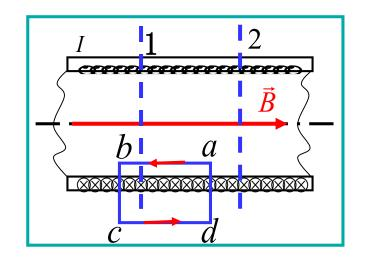
线密绕:  $\vec{B}_{\text{sh}} = 0$  作矩形安培环路如图,规定  $f_{\oplus}$
