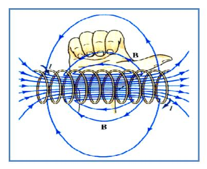
螺线管内只具有沿轴向的相同分量 $B_x$  在螺线管外部  $\mathbf{B}_y = 0$
